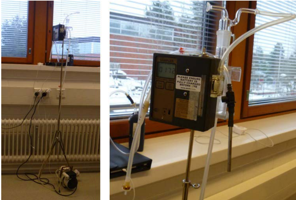
Kuva 3. Kuva kemiallisten yhdisteiden näytteenkeruusta.
