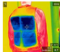
Kuva c_18. Keskimääräinen iholämpötila rasiuksen aikana 30 asteessa (ei jäähdystä) ja levon aikana 22 °C:ssa jäähdytyspukinetta käytettäessä tai ilman. Nuoli = työ loppuu 30 °C:ssa ja tauko alkaa 22 °C:ssa. (N = 5). Huom. kuvassa vain työajan viimeiset 20 min. Lämpökamerakuvissa viileä- ja kylmäliivi.
