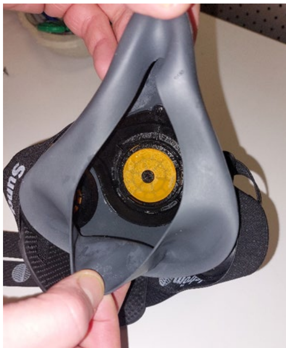
Kuva 9: Pari millilitraa vettä Sundström SR 900 puolinaamarin sisällä testien alkaessa.
