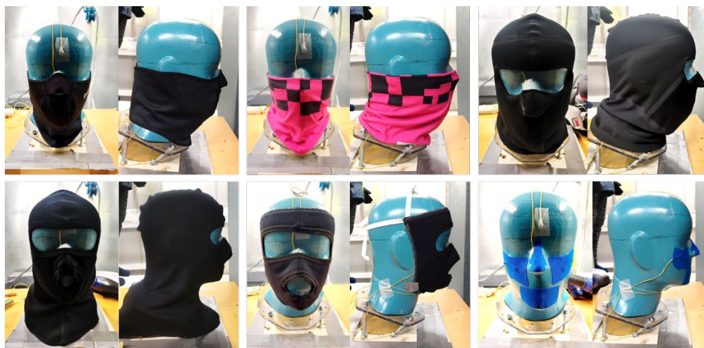
Kuva 15: Testatut kasvojen kylmänsuojausmenetelmät. Yläriivi: Tuulensuojakauluri, tuubihuivi, tuulensuoja-alushoppu. Alariivi: Merinovilla-alushoppu, TTL Kasvojen Kylmänsuoja ja kasvoteipit. Hengityksensuojaimena oli kypäräsuojain M-306 ja Versaflo-puhallin (3M).
