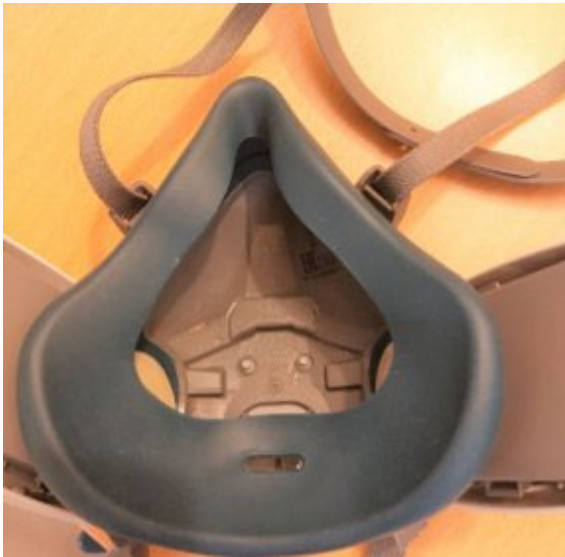
Kuva 11: Puolinaamari 3M 3600 jäädytystestin jälkeen. Ohut jääkerros sulii nopeasti suojainta kuvattaessa.
