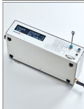
KUVA 3. Alveolijakeisen pölyn pitoisuusvaihtelu suhteessa hengittyvään pölyyn ja keuhkojakeeseen suoraan osoittavalla laitteella mitattuna (yllä). Vasemmalla on kuva ko. suoraan osoittavasta laitteesta (Grimm, GRIMM Tehcnologies).
