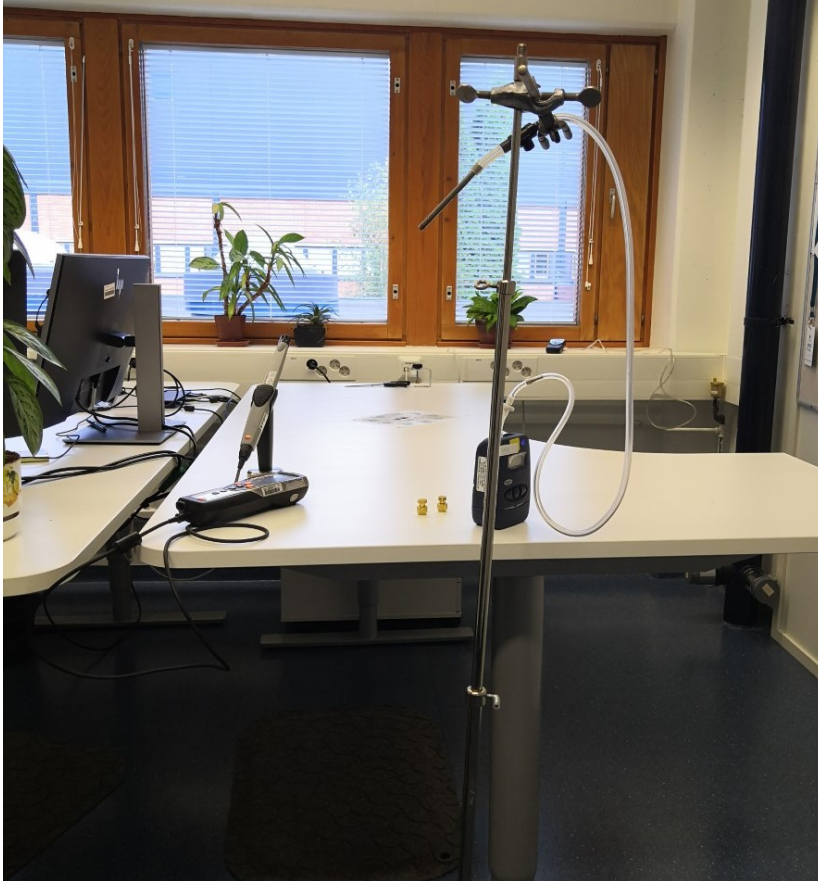
Kuva 2. Lämpötilan, suhteellisen kosteuden ja hiilidioksidin mittaus Testo 435 -mittarilla sekä VOC-näytteenotto toimistossa Tenax TA®-adsorptioputkeen SKC AirChek 3000 pumpun avulla.
