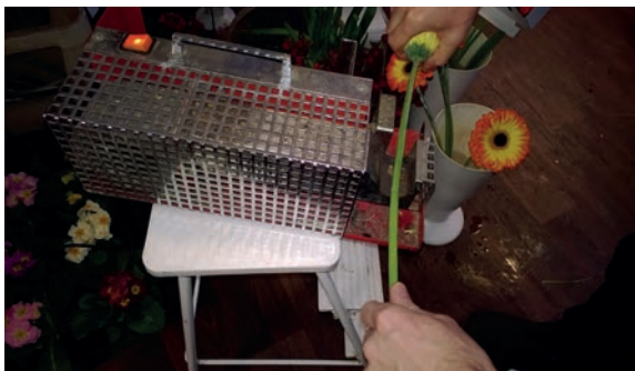
Kuva 14. Kukkien varren ympärille sulatettiin muovia tukemaan niitä. Työvaihe aiheutti hetkellisen nanohiukkasten pitoisuuden kohoamisen työtiloissa.
