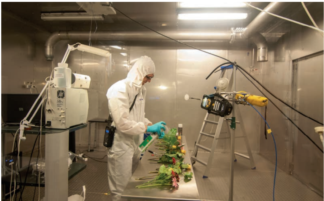
Kuva 5. Työvaiheita simuloivat mittaukset suoritettiin laboratoriotilassa, jossa taustailman hiukkas- ja kaasupitoisuudet olivat erittäin pienet ja hallitut. Tutkijan suojavaatetus esti ihosta ja vaatteista irtoavien epäpuhtauksien pääsyn tutkimustilaan.
