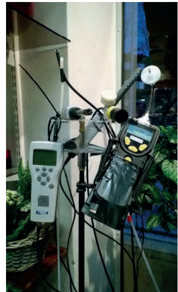
Kuva 3. Mittalaitteiden näytteenottolinjat asennettiin noin 1,4 m korkeuteen vastaamaan mahdollisimman hyvin työntekijän hengitysvyöhykettä.
