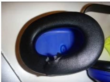
Kuva 13. Rikkinäisiä kupuja, vaimennus 4-6 dB
