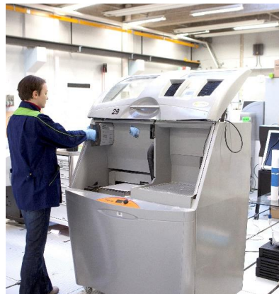
Kuva 7. Sideaineen suihkutukseen perustuva teollinen 3D-tulostin.
