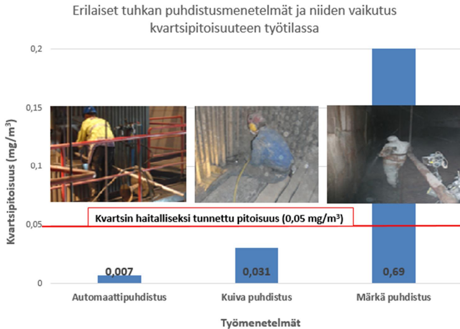
Kuva 28. Automaattipuhdistuksen aikana työntekijän altistuminen kvartsilille on vähäisintä, koska työntekijän ei tarvitse olla kattilalaitteiden sisällä puhdistamisen aikana.
