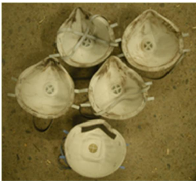
Kuva 2. Kertakäyttöiset hengityksensuojaimet eivät anna riittävää suojaa työntekijälle kattilan sisäpuolisten työvaiheiden aikana.
