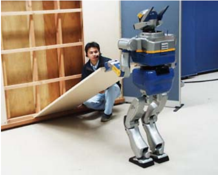
Kuva 29. HRP-2 avustamassa seinäpanelin asennuksessa. Lähde: http://www.sciencedirect.com/science/article/pii/S0921889004000946
