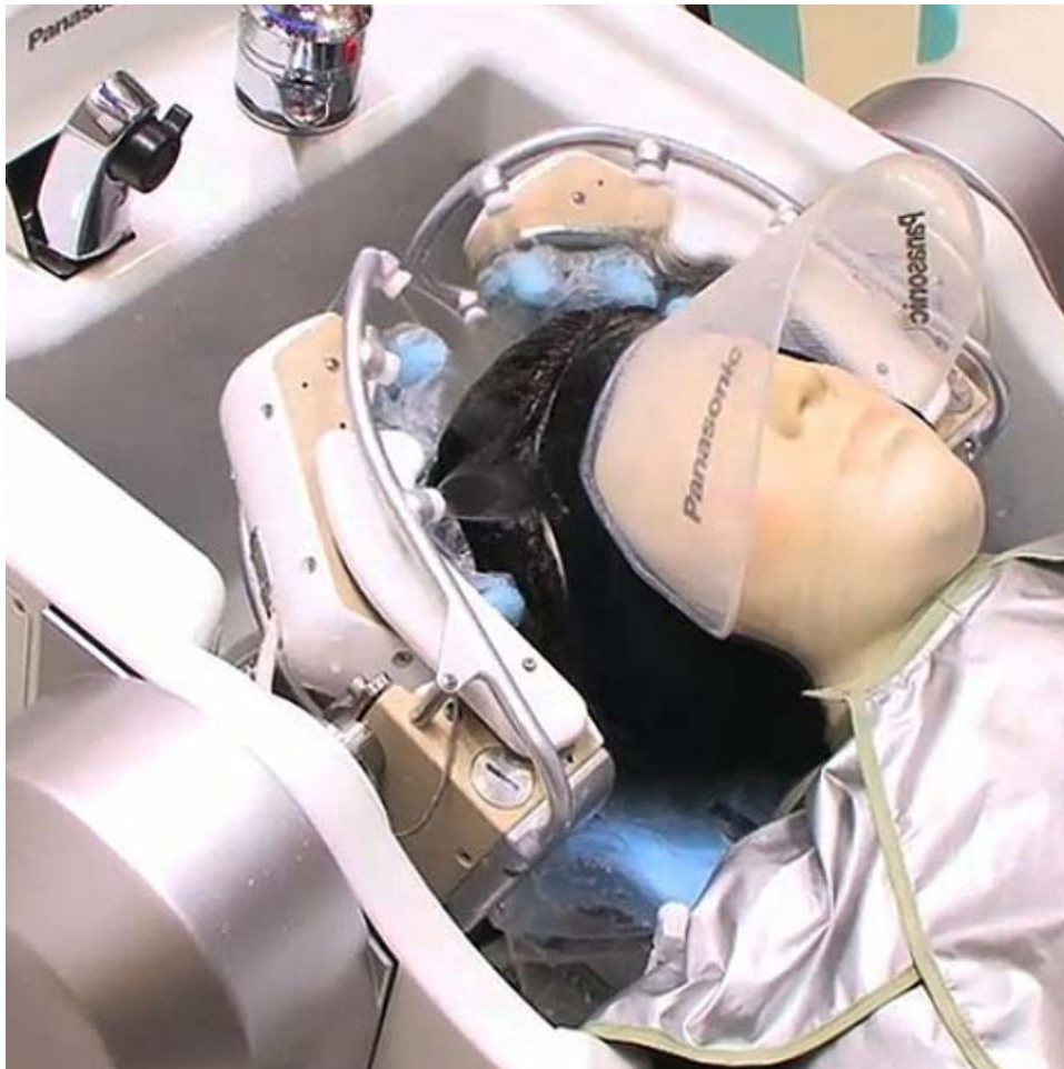
Kuva 9. Hiustenpesurobotti, joka pesee, kuivaa ja hieroo niskan. Lähde: http://technabob.com/blog/2010/10/13/hair-washing-robot-panasonic/
