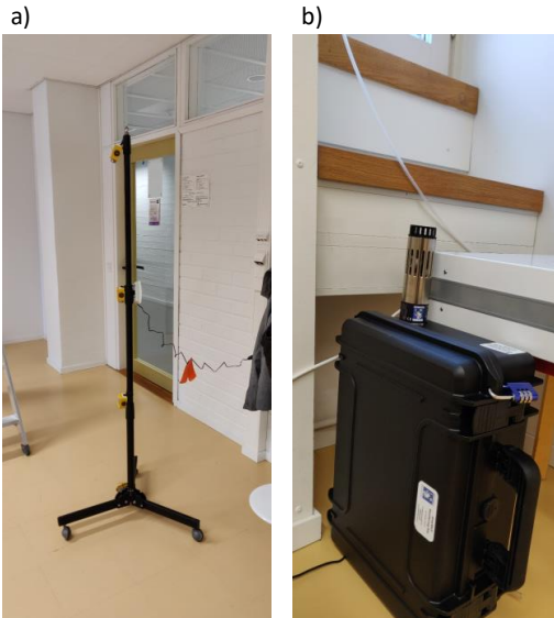
Kuva 5. Mittauskohteen mittalaitteet: a) huoneilman lämpötilan ja kosteuden mittausmasto, b) kaasujen mittaus.
