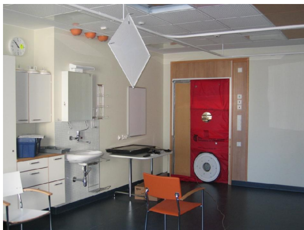
Kuva 4.4. Oviaukkoon asennettu Blower Door™ tiiviysmittauslaitteisto.
