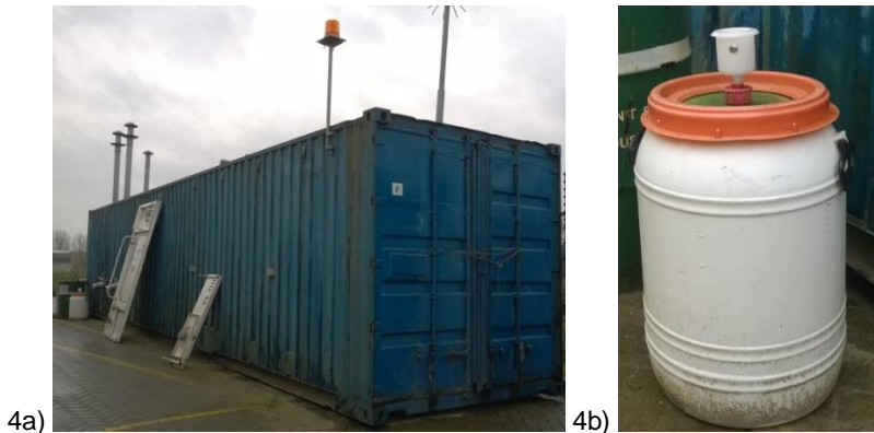
Kuvat 4 a ja b. a) Erillinen kontti, jossa kaasutusaineiden talteenotto tehdään aktiivihillitynnyreihin, b) fosfidipellettien keräysastia.
