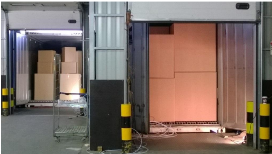
Kuva 4. Harvasti ja tiiviisti täytetyt tutkimuskontit Hakkilassa 27.2.–8.5.2015.
