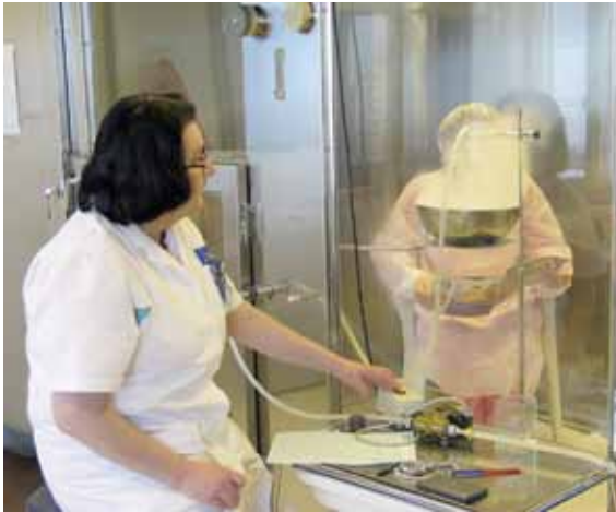
KUVA 1. Jauhoaltistuskoe altistuskammiossa Työterveyslaitoksella.
