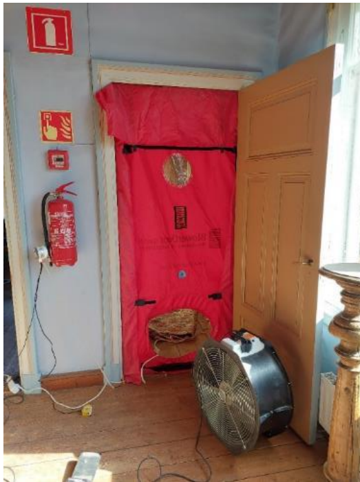
Kuva 41. Tutkittavan tilan alipaineistusjärjestelyjä ja paine-eron seuranta.
