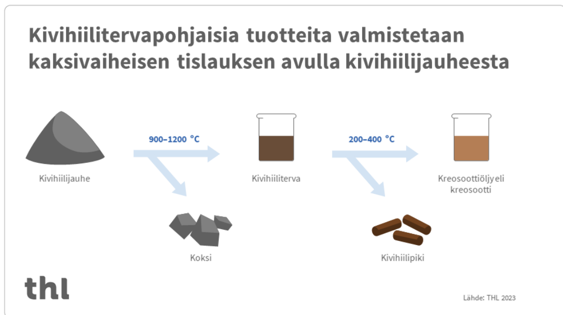
Kuva 1. Kivihiilitervapohjaisten tuotteiden valmistus. Lähde: Airaksinen ym., 2023.
