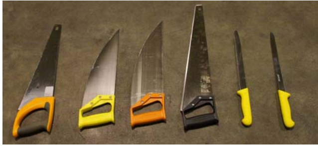
Kuva 4. Asennustyössä käytettyjä villasahoja ja -veitsiä. Työparit saivat käyttää myös mukana olleita omia työkalujaan.
