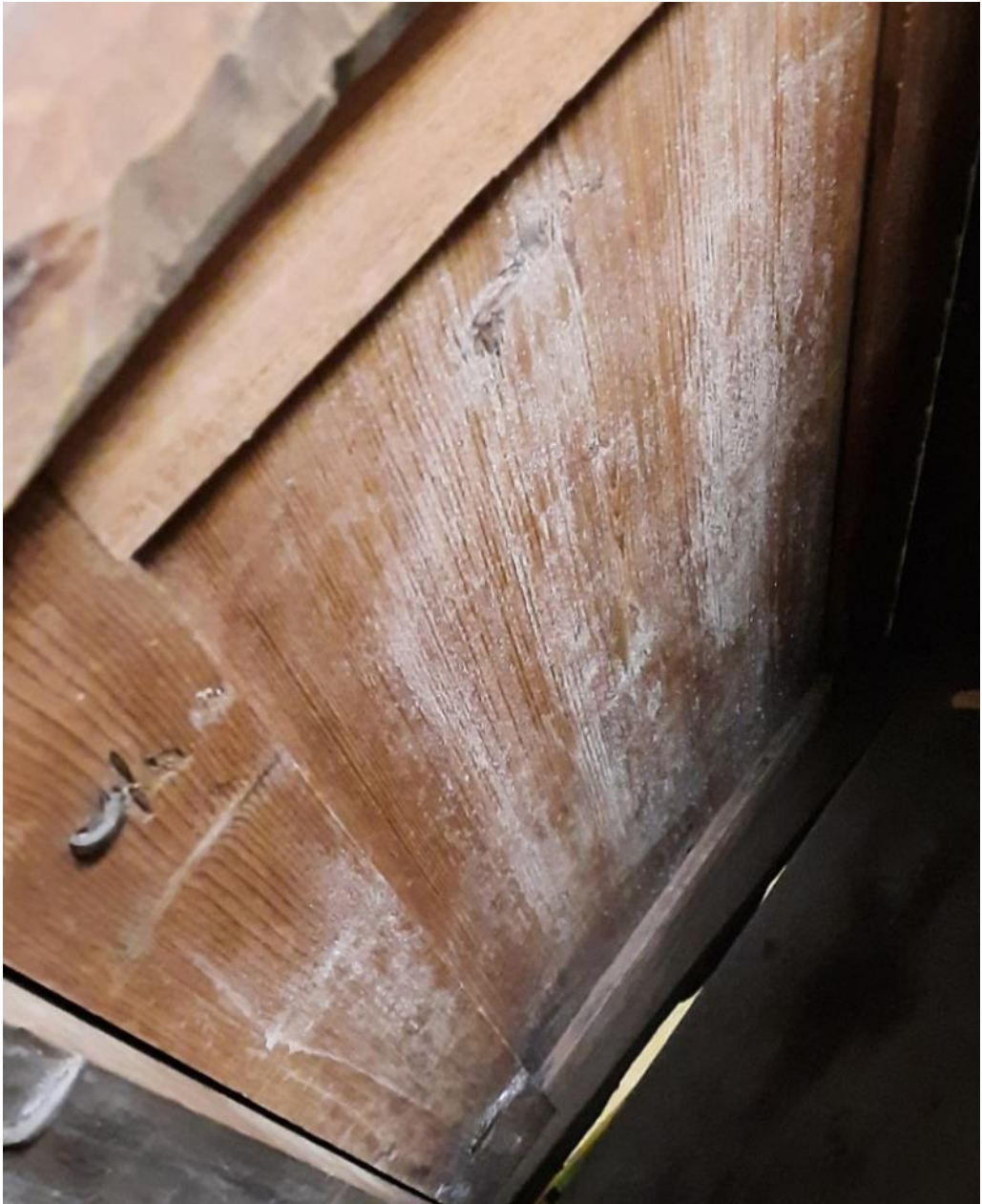
Kuva 12. DDT-kiteitä puisen huonekalun pinnalla. Kuva: Henna Sinisalo, TTL.
