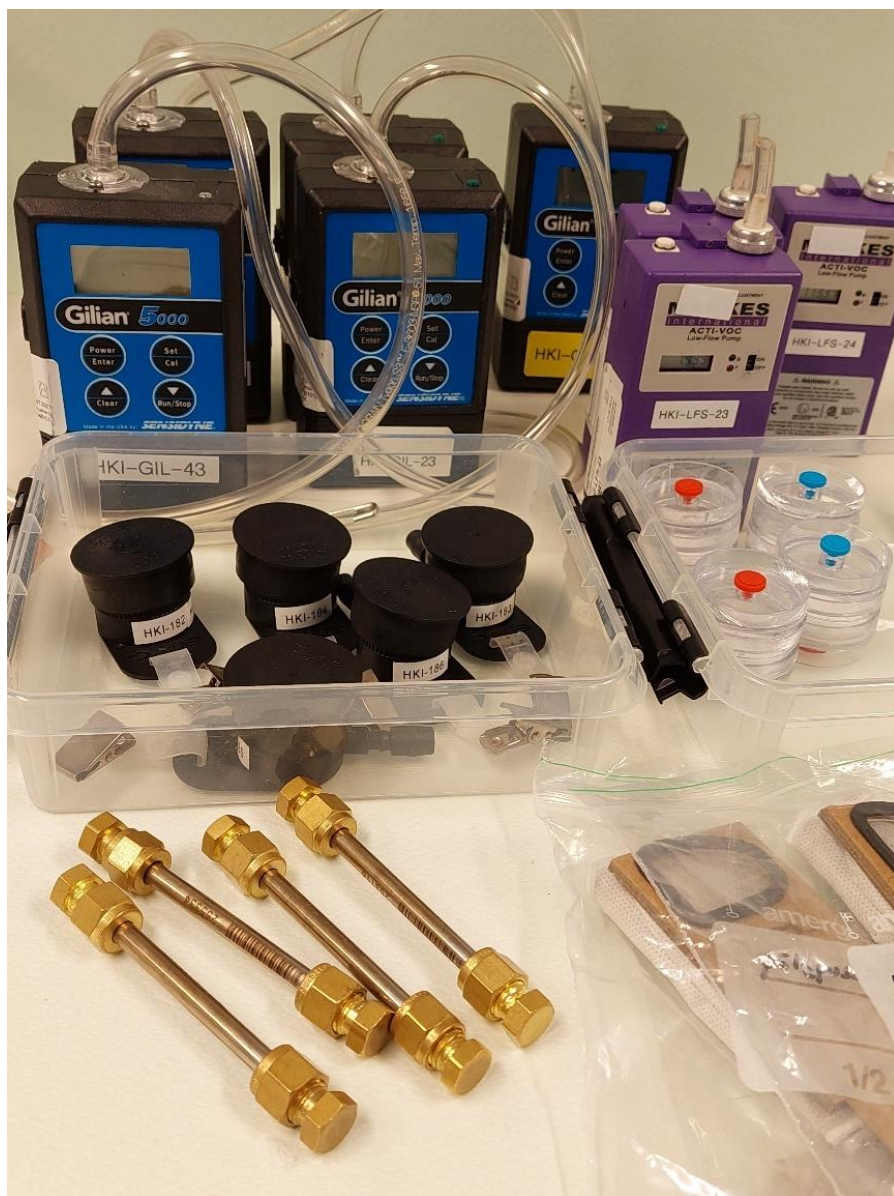
Kuva 1. Näytteenottovälineistöä. Takarivissä on näytteenottopumppuja, keskellä ja eturivissä keräimiä. Kuva: Katriina Ylinen, TTL.
