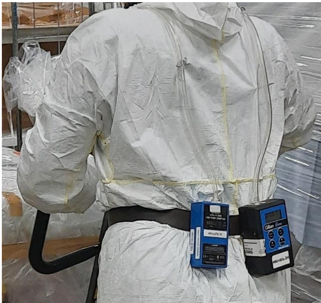
Kuva 2. Kaksi näytteenottopumppua työntekijän vyötäröllä hengitysvyöhykemittauksen aikana. Kuva: Henna Sinisalo, TTL.
