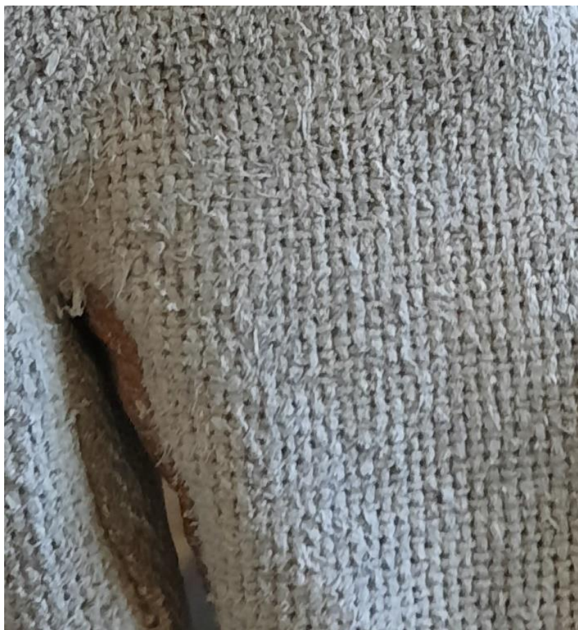
Kuva 10. Asbestitekstiilistä irtosi kevyellä pyyhkimisellä asbestikuituja näytteenottovälineenä toimineeseen Minigrip-pussiin. Kuva: Henna Sinisalo, TTL.
