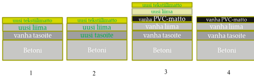
Kuva 1. Näytteiden rakenteet kammiossa tehdyissä VOC-emissiotestauksissa
