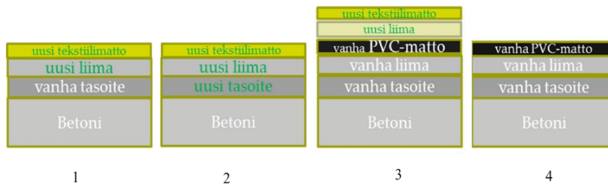
Kuva 1. Näytteiden rakenteet kammiossa tehdyissä VOC-emissiotestauksissa.
