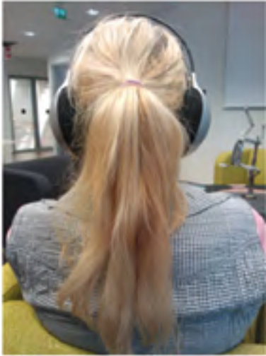
Kuva 16. Ääninäytteet kuunneltiin binauraalisesti stereokuulokkeilla (Sony Stereo Headphones MDR-CD480).
