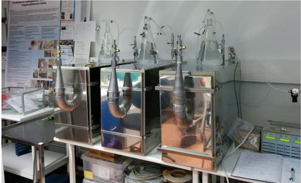
Kuva 13. Koekammiot suljettuina ensimmäisen koesarjan alussa. Kammioiden päällä on vesiasiat, joiden läpi osa paineilmasta johdettiin sopivan suhteellisen kosteuden saavuttamiseksi. (Nuutinen 2017)
