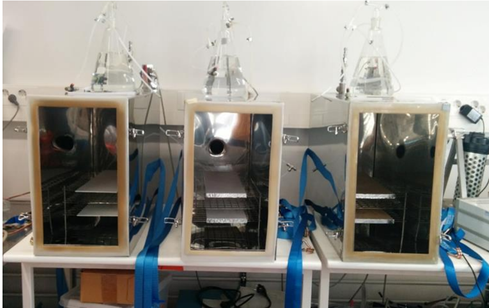
Kuva 14. Näytekappaleet on asetettu keskelle kammiota, niin että ilmavirta pääsee kulkemaan vapaasti kappaleiden pinnalla. (Nuutinen 2017)
