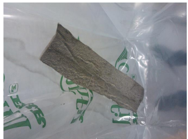
Kuva 4. Ilmanvaihtokoneen poistoilmasuodatin ja siitä mikrobien viljelyä varten leikattu näytepala.
