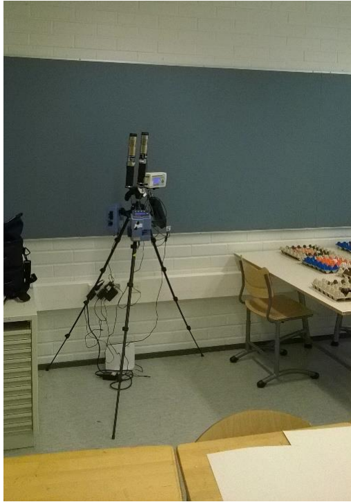
Kuva 1. Jatkuvatoinen hiukkasten ja VOCien mittaus kenttätutkimuskohteissa.
