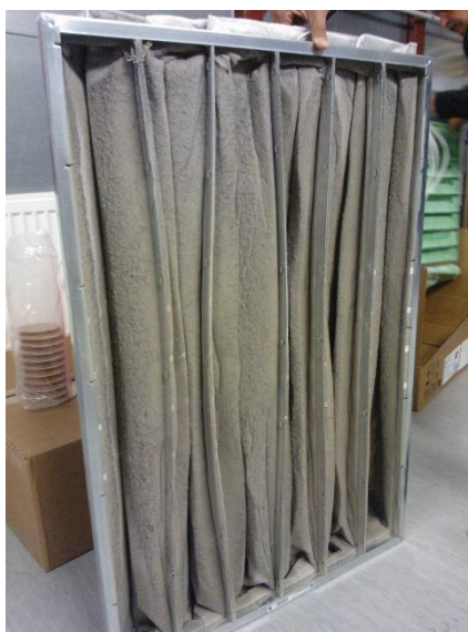
Kuva 4. Ilmanvaihtokoneen poistoilmasuodatin ja siitä mikrobien viljelyä varten leikattu näytepala.
