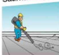
Puhdista saumat kasaan, jätetä ja roskista. Tarkista seinälaatan liikkuvuus ja muoto saumat.
