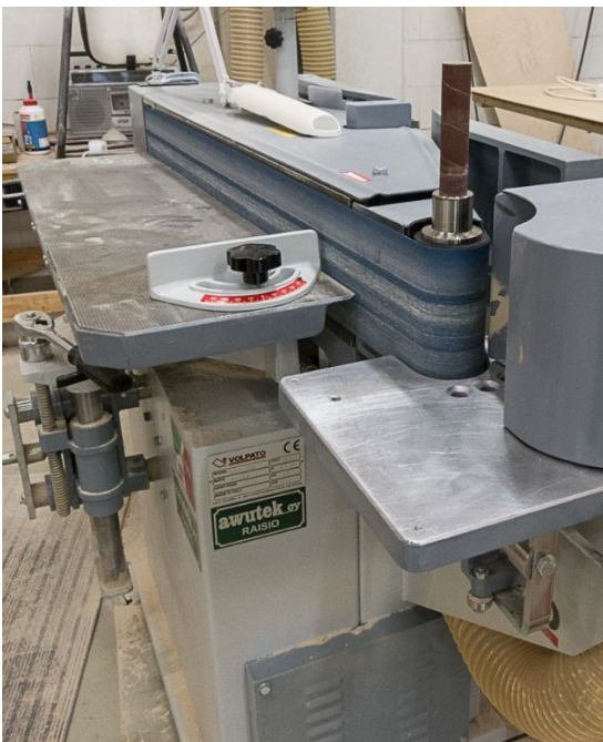
Kuva 25. Työpaikkakäyntien parhaiten koteloitu kapeanauhahiomakone edestä ja takaa.
