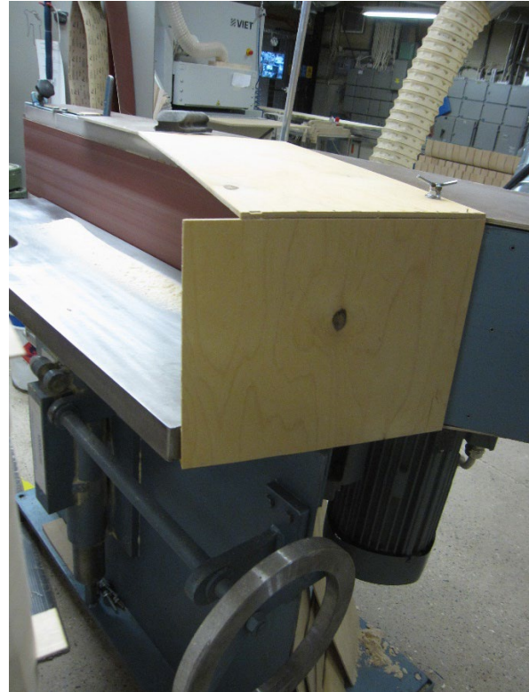
Kuva 24. Kapeanauhahiomakoneeseen itse rakennettu lisäohjain.
