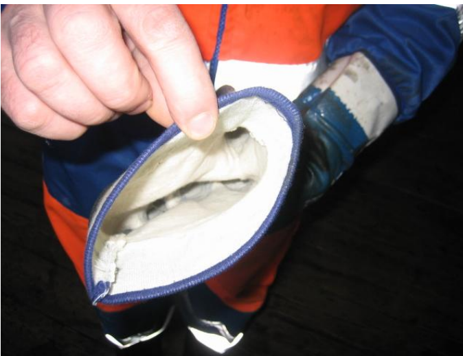
Kuvat 14. Suojäkäsineiden vaihtotiheyttä lisättiin tehoviikolla. Pinnalta likaantuneet käsineet olivat yhä sisältä puhtaat.
