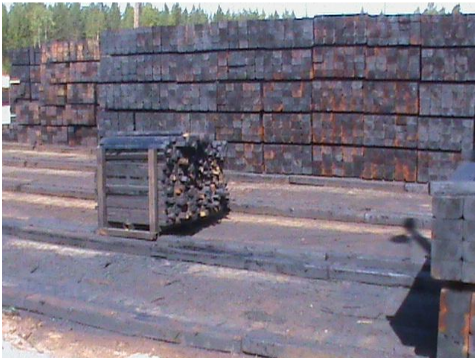
Kuva 5. Kyllästetyt ratapölkyt on varastoitu kylästämörakennuksen lähelle.
