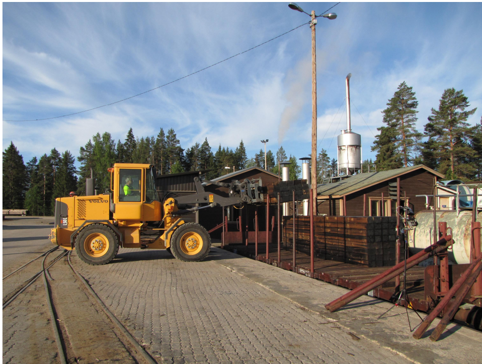
Kuva 1. Kyllästettyjen ratapölkkyjen lastausta. Aamulla käytetty pölyjen ja PAH-höyryjen kiinteä mittauspiste näkyy kuvan oikeassa alanurkassa.
