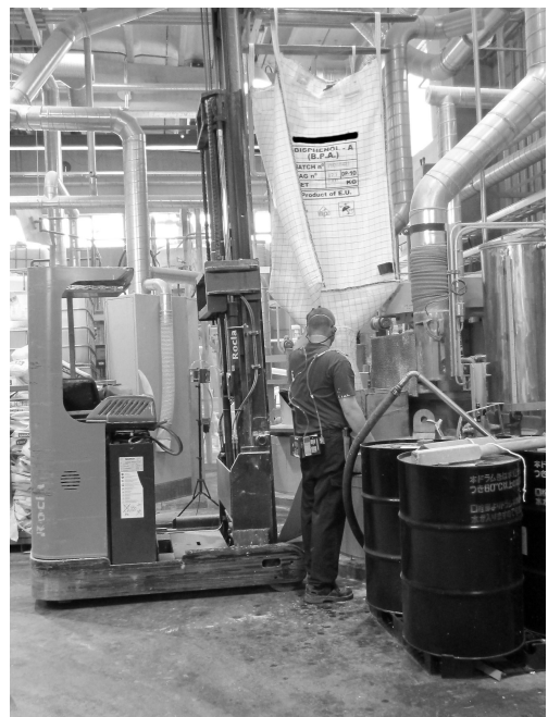
Kuva 5. 1000 kg BPA-säkin tyhjentäminen päällystyskeittämöllä. Säkkiä tyhjentävä työntekijä käytti hengityksensuojainta. Valokuvat: Katriina Ylinen, Työterveyslaitos, 2013.
