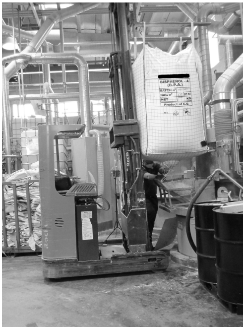
Kuva 5. 1000 kg BPA-säkin tyhjentäminen päällystyskeittämöllä. Säkkiä tyhjentävä työntekijä käytti hengityksensuojainta. Valokuvat: Katriina Ylinen, Työterveyslaitos, 2013.
