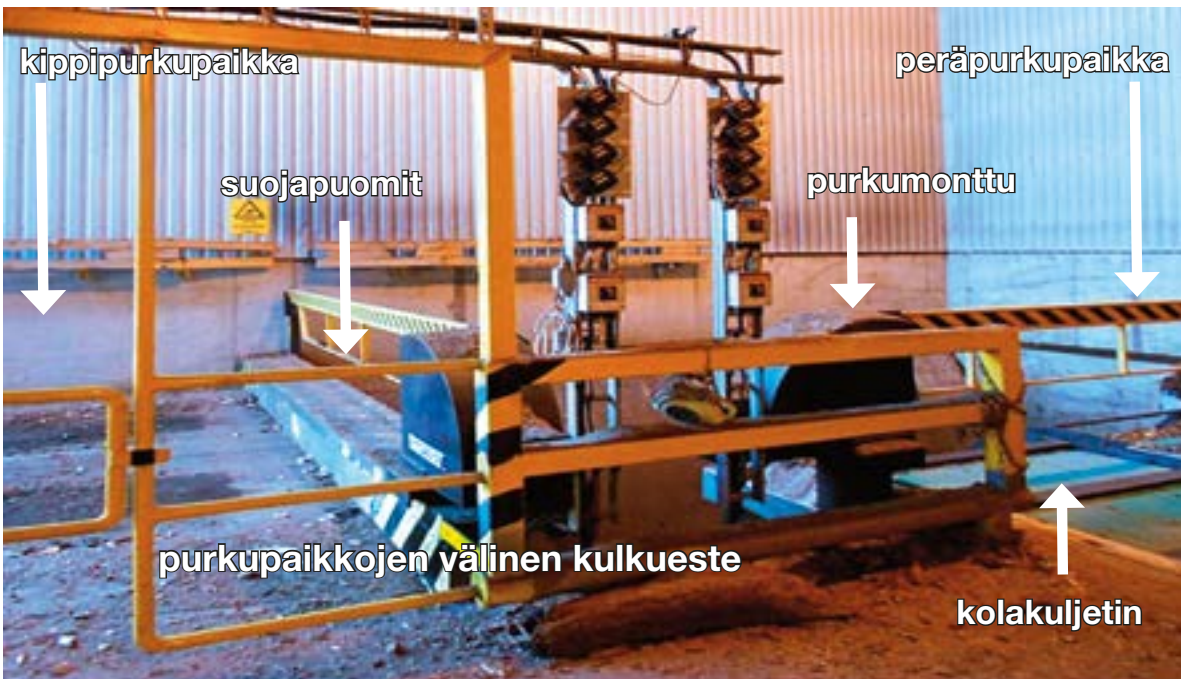
Kuva 9. Suojapuomit, jotka kiinni mennessään kytkevät pois päältä purkumontun pohjalla olevan kuljettimen. Lisäksi vasemmalla hyvä esimerkki siitä, miten kulkemista voidaan rajoittaa ja ohjata tiloissa (TOT 4/10).
