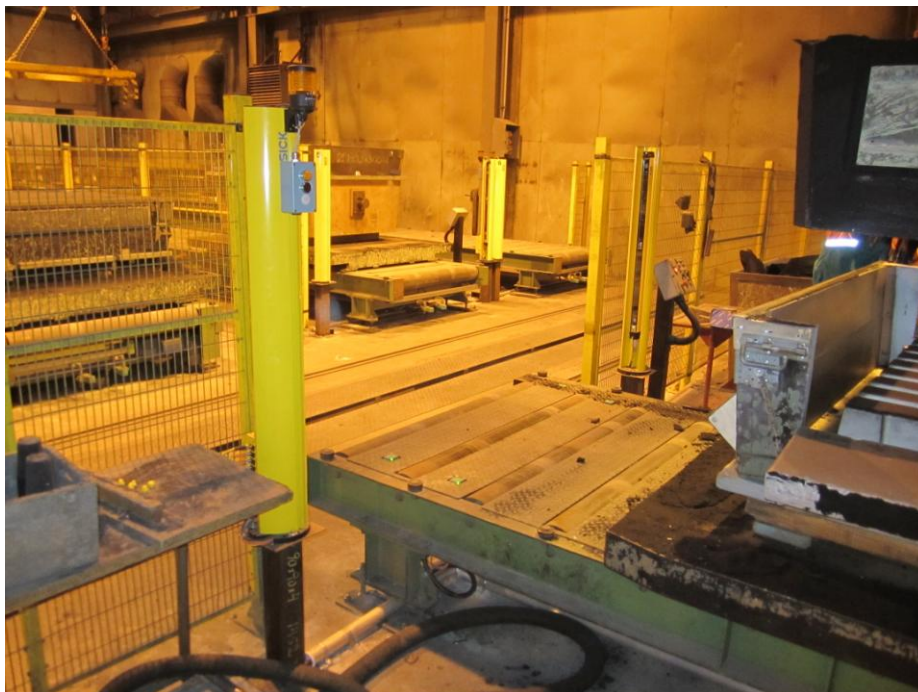
Kuva1. Kuvassa passivoitava valoverho, joka mahdollistaa tuotantokappaleiden liikkeen, mutta joka pysäyttää tuotantolinjan, kun ihminen kulkee aukosta linjalle.
