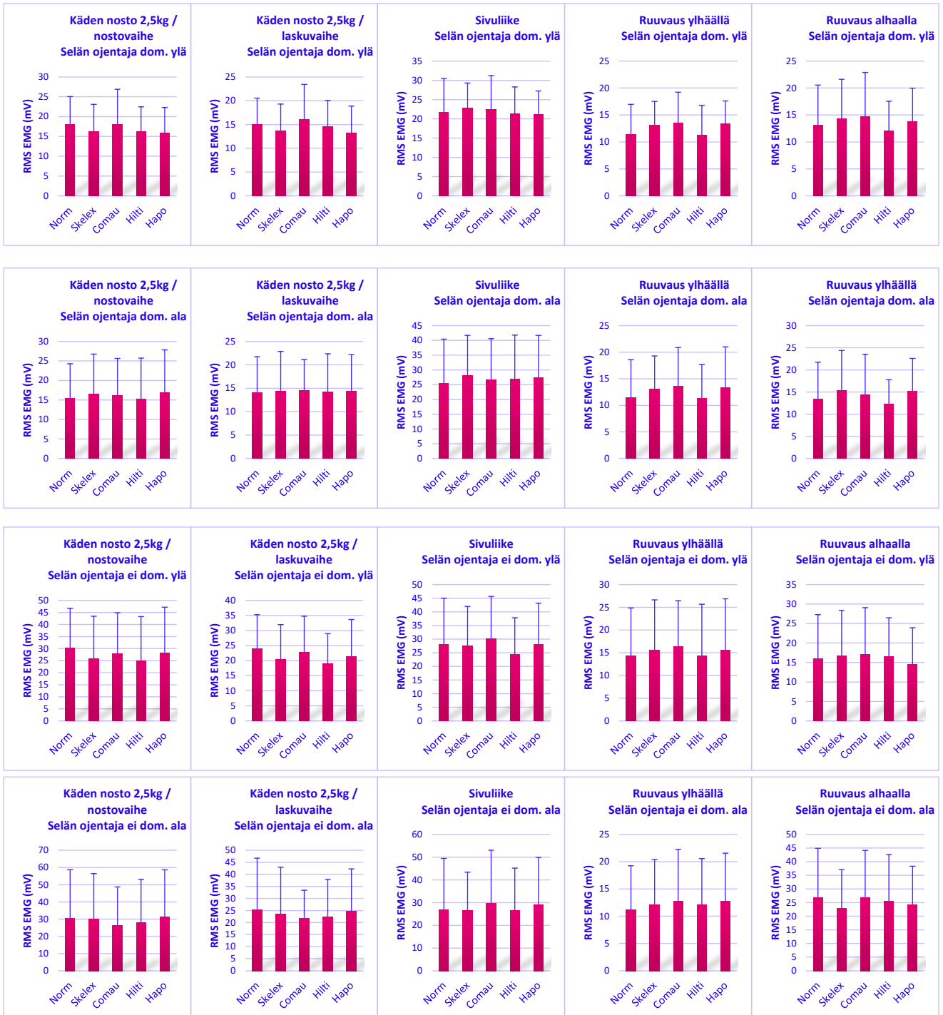
Kuva 10. Selkälihasten aktiivisuudet laboratoriomittauksessa.
