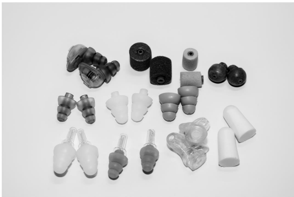
Kuva 1. Tutkimuksessa käytetyt kuulonsuojaimet. (Kaksi ylimmäistä riviä: elektroniset suojaimet ja erilaiset tulppavaihtoehdot, Alin rivi: High-Fidelity tulpat, kaksi eri kokoa, muotoon valetut tulpat, kertakäyttöinen vaahtomuovitulppa)
