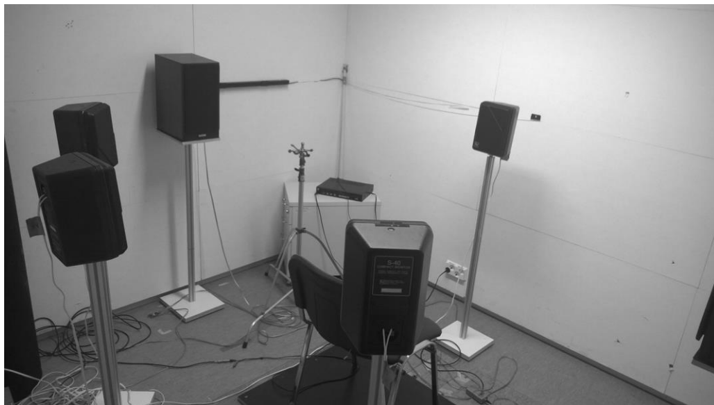
Kuva 2. Koejärjestely QuickSIN™ -testiä varten
