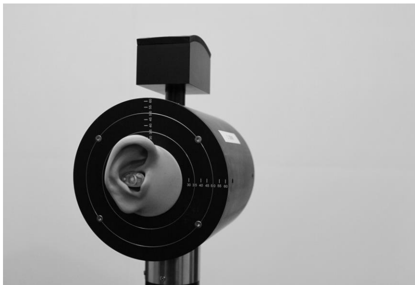
Kuva 4. GRAS45CA-keinopää ja korvasimulaattori IEC 60318-4 (60711), joka soveltuu tulppasuojaintestaukseen
