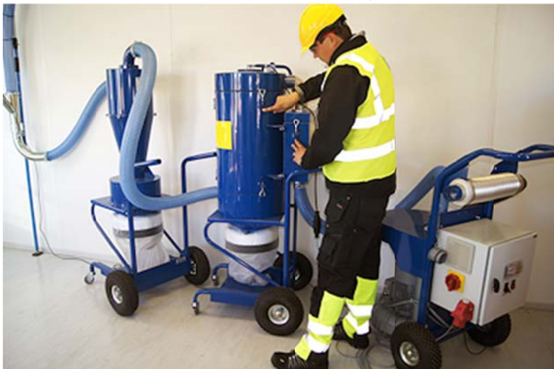
Keskuspölynimuri, jossa erilliset esisuodatus-, suodatus- ja moottoriyksiköt
