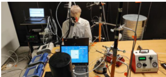
Kuva 5. Hengittävä lämpönukke (valkoinen paita).
