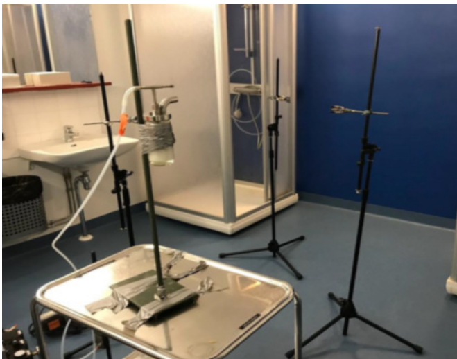
Kuva 45. Suuntaa antava kuva koejärjestelystä. Näytteenottopisteet A, B ja C ovat keskellä kuvaa kolmella jalustalla ja viruksen tuotto Collison Nebulizerilla kuvan etualalla.
