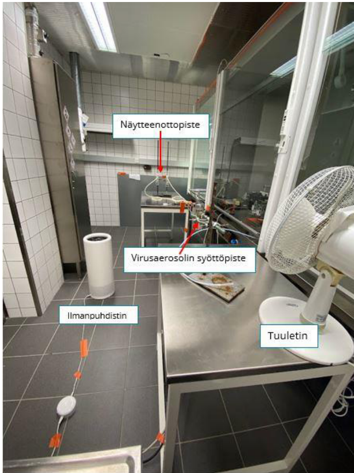
Kuva 46. Koejärjestely. Etualalla oleva tuuletin edisti ilman sekoittumista tilaan, ja kokeessa käytetty ilmanpuhdistin oli sijoitettu virusaerosolin syöttöpisteen ja näytteenottopisteen väliin.
