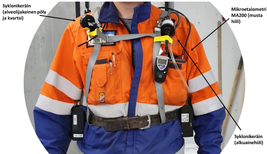
Kuva 1. Kaivostyöntekijä yllään syklonikeräin alveolijakeisen pölyn ja kvartsin mittaamiseen, syklonikeräin alkuainehiilen mittaamiseen ja mikroetalometri mustan hiilen mittaamiseen.
